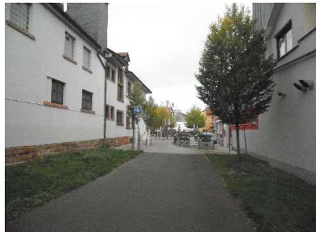
Geh- und Radweg hinter der Bebauung mit Fahrriechung Dreschhalle. Relativ eng gehalten, z.T. Wie im Bild unübersichtlich. Für Zweirichtungsverkehr Fahrrad definitiv zu schmal (ERA 2010!).
